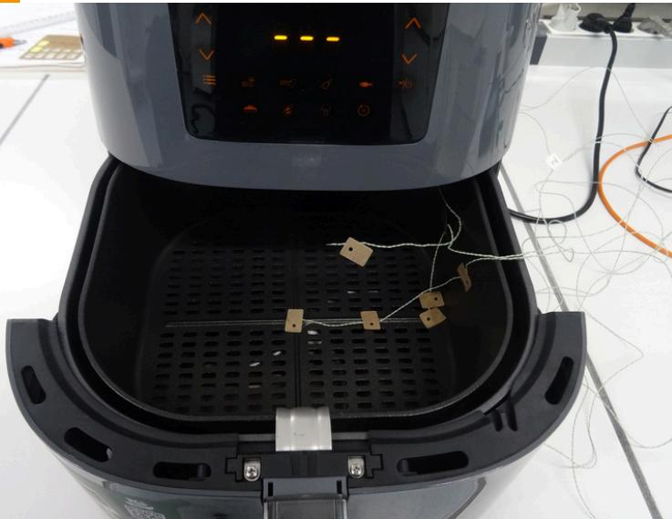
En parallèle, un nouvel essai a été développé au laboratoire pour reproduire la répétition de chocs thermiques sous air pulsé à des températures supérieures à celles pouvant être atteintes dans les appareils à cuisson Airfryer.
